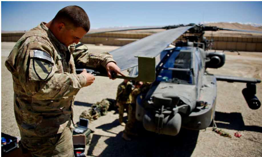
Рис. 11. Регулировка лопасти НВ вертолета Апач АН-64А
